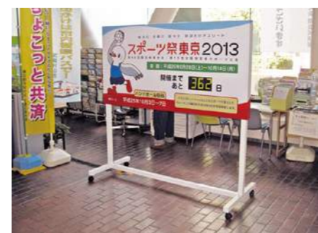
武蔵村山市/サイズ:W1,800×H900mm 可動式サイン 電磁反転ユニット 文字高:103mm
