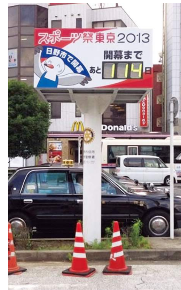
日野市/サイズ:W1,835×H918mm 電磁反転ユニット 文字高:229mm
